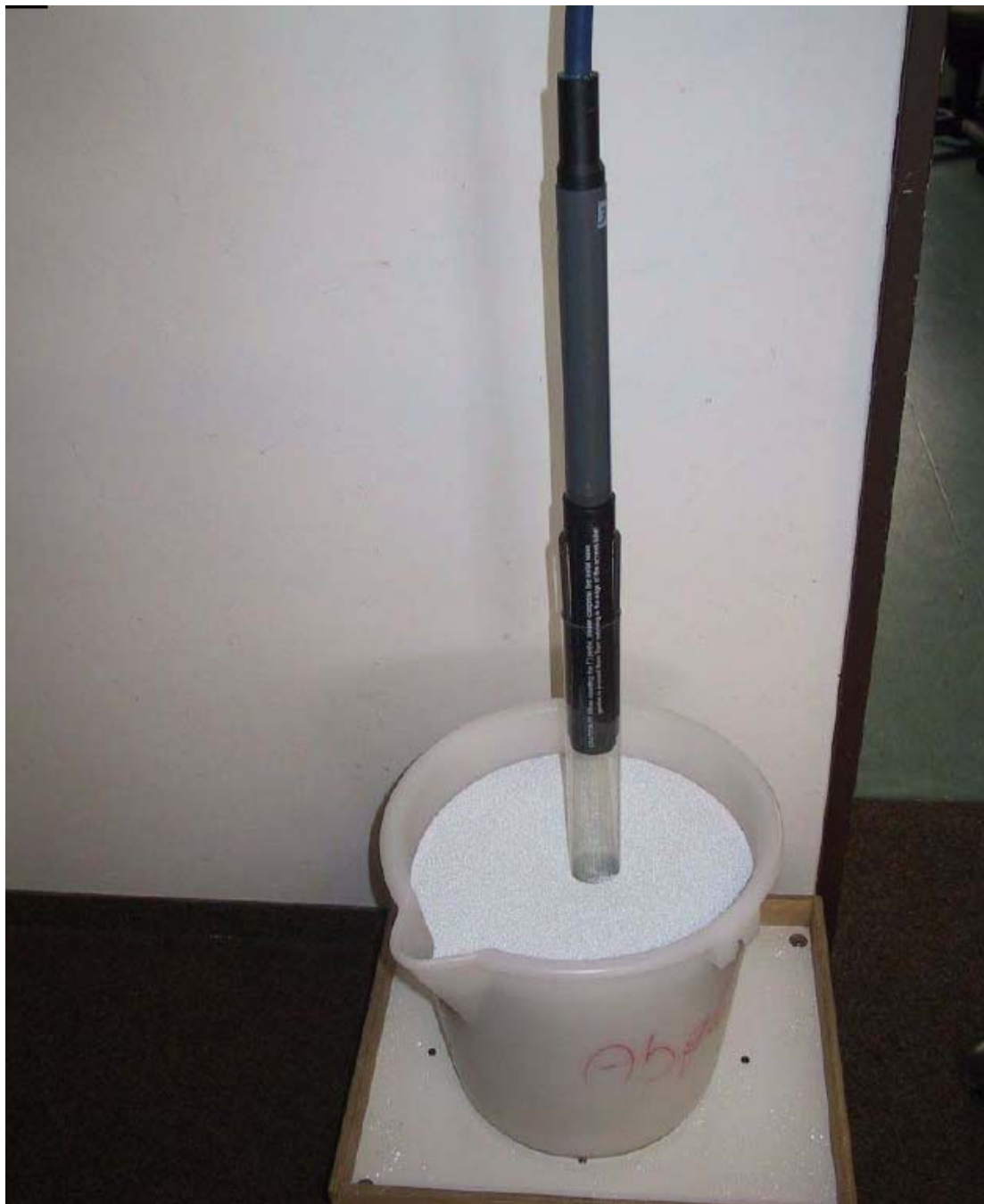
图：使用 T3 探头的 TRIME-IPH 套在套管中插入干燥的玻璃珠。一定要确保探头的测波体完全进入到玻璃珠中，如果测波体周围有空气，测量会失败。
